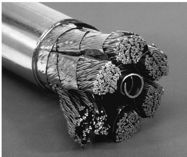
Fig. 1. - Progetto NET ITER: cavo superconduttore  $Nb_3Sn$  per bobina toroidale.
