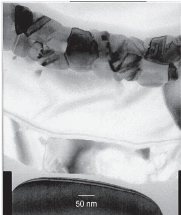
Fig. 4. – fotografia TEM della sezione di una cella di memoria flash (particolare).
