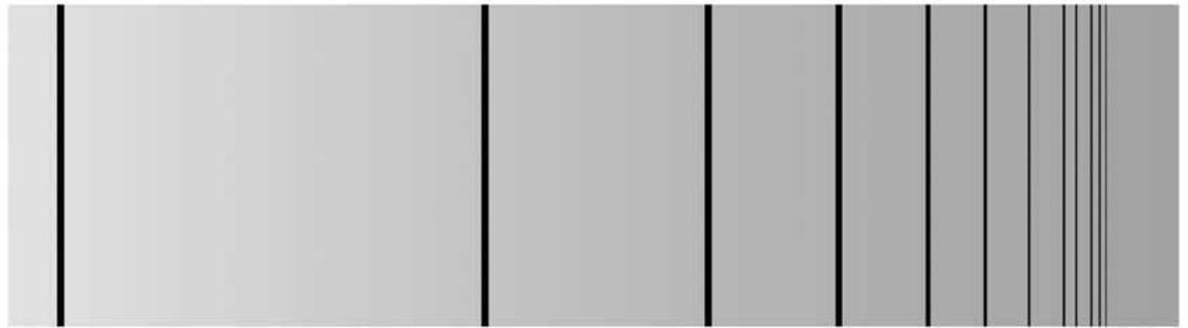
Fig. 3 La serie di Balmer dello spettro dell'idrogeno: le prime quattro righe si trovano nel visibile alle lunghezze d'onda (in nanometri):  $H_{\alpha}$ , 656,3;  $H_{\beta}$ , 486,1;  $H_{\gamma}$ , 434,1 e  $H_{\delta}$ , 410,2; le altre nell'ultravioletto col valore limite a  $H_{\infty}$ , 364,6 nm.
